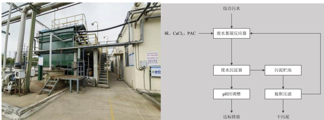
污水处理站及污水预处理工艺流程图
